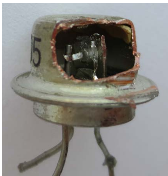
Рисунок 4.21. Фотография транзистор со спиленной крышкой
