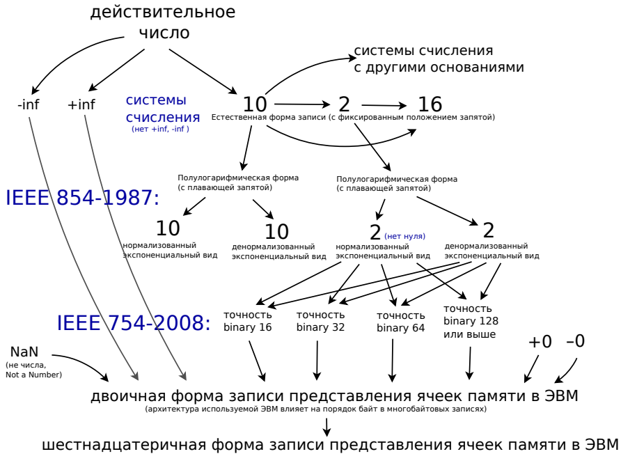
Рисунок 2.2 а Типичные направления движения мыслей между сущностями (рассмотрен лишь один вариант перехода для записи в память ЭВМ, подразумевая что он будет для порядка LittleEndian)
