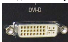
Рисунок 4.46 Разъёмы DVI для подключения монитора к системному блоку ПК и PS/2 – мыши и клавиатуры
