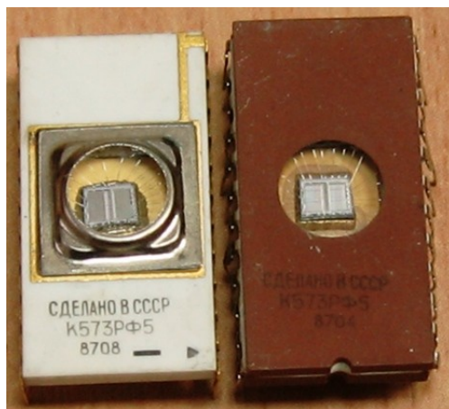
Рисунок 4.62. Фотография микросхем ПЗУ ( http://www.1551a3.ru/k573.htm )
