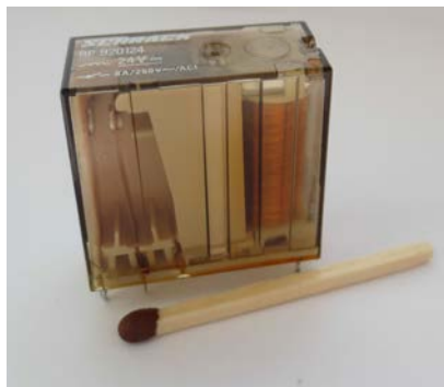
Рисунок 4.12. Электромагнитное механическое реле
