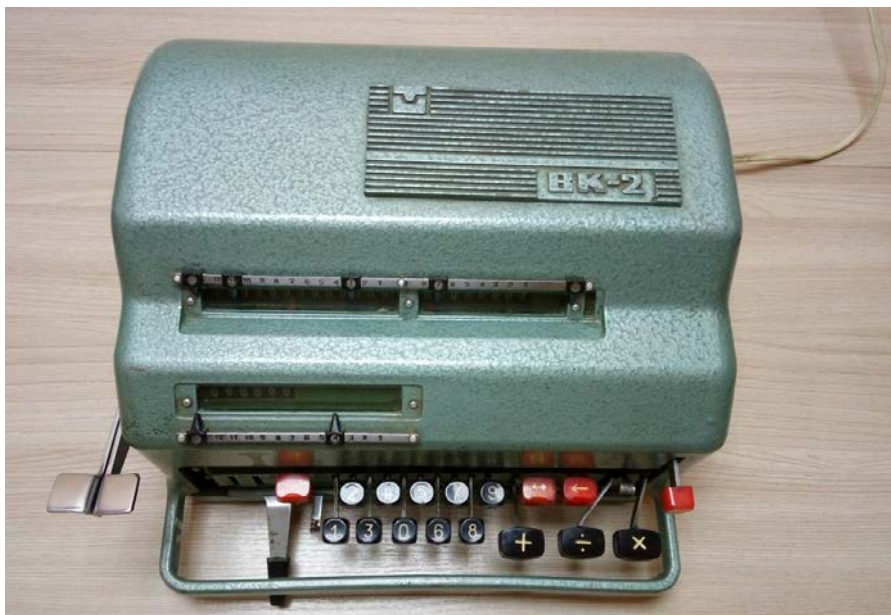
Рисунок 4.6. Электромеханический арифмометр ВК-2 (1974 г.в.)
