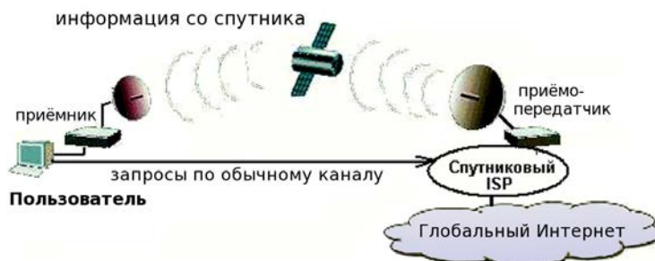
Рисунок 6.16. Схема асимметричного спутникового доступа в интернет
