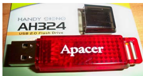
Рисунок 4.77. USB-flash-накопитель Apacer AH324 ёмкостью 16 ГБ
