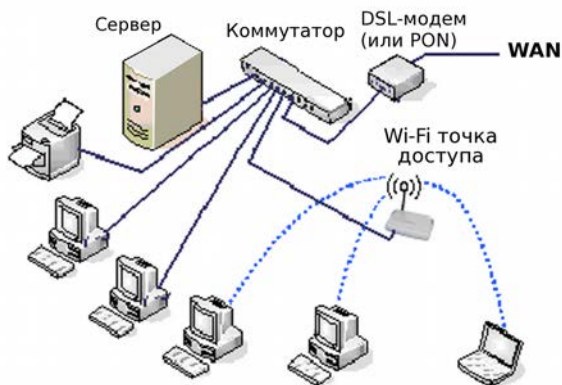
Рисунок 4.109. Пример локальной сети с использованием Wi-Fi
