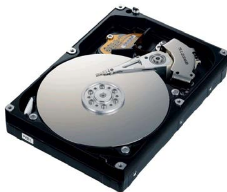
Рисунок 4.50. Винчестер со снятой верхней крышкой (модель Samsung HD103UJ, 1000 ГБ, 7200 об./мин)
