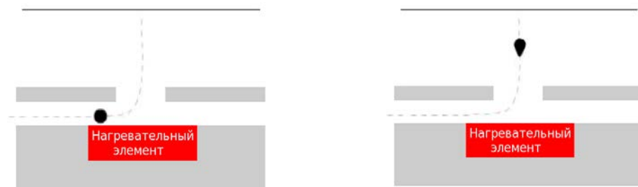
Рисунок 4.98. Принцип технологии drop-on-demand фирмы Hewlett-Packard
