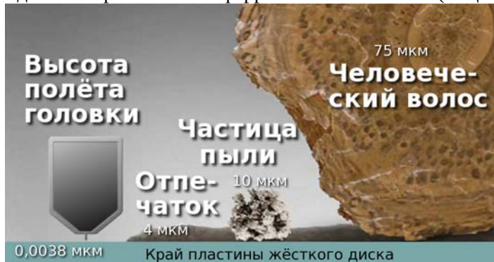
Рисунок 4.51. Сравнение высоты «полёта» головки современного жёсткого диска с размерами отпечатка пальца, частичкой пыли и человеческим волосом 173
