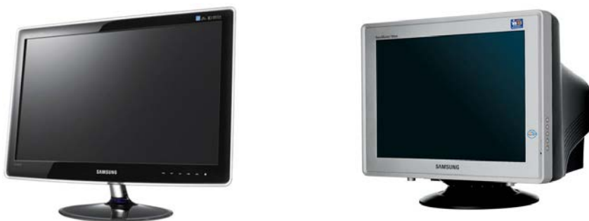
Рисунок 4.91. ЖК- и ЭЛТ-монитор
