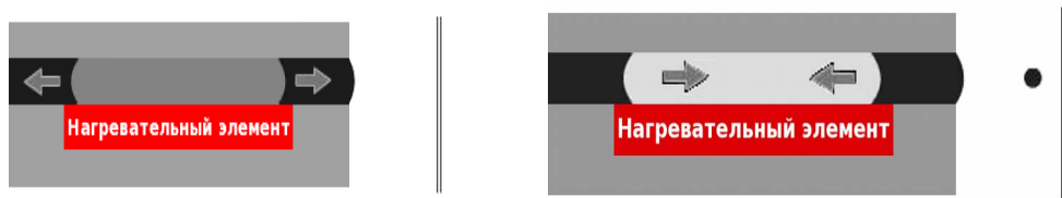
Рисунок 4.97. Принцип пузырьковой технологии ( bubble-jet ) фирмы Canon
