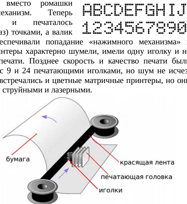
Рисунок 4.100. Матричная печать: иглолки печатающей головки прижимают ленту с краской к бумаге
