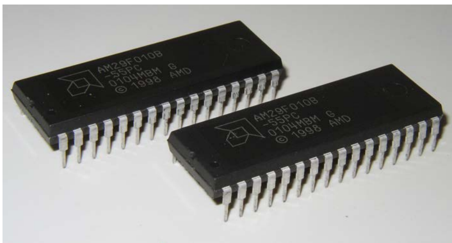
Рисунок 4.65. Пример микросхемы flash-памяти ёмкостью 128 Кбайт
